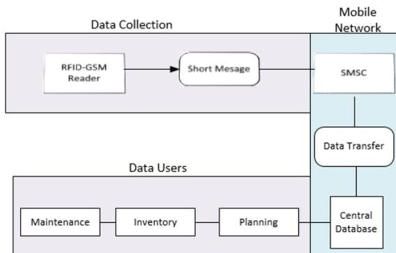
**Figure 9: RFID-Software Structure.**
